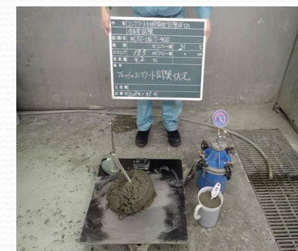
WC55-CUS-400 フレッシュコンクリートの状況
