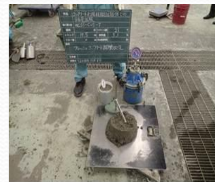
WC55-CUS-350 フレッシュコンクリートの状況
