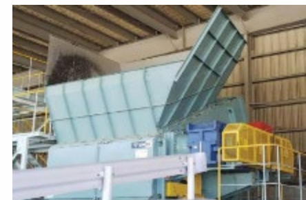
太平洋セメント(株) 大分工場廃プラ粉碎機 (CSRレポート2019 p.47)
